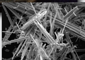
Eine Rasterelektronenmikroskop (REM) Aufnahme von Anthophyllit, ein Asbest aus der Amphibolgruppe
